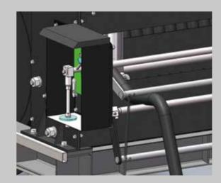
特殊的收放线控制机构,获得国家专利。电缆卷筒能够自动卷电缆和放电缆,收放电缆速度保持与抓料机行走,不会囤积多余电缆被车碾压和拉力过大损坏电缆。
