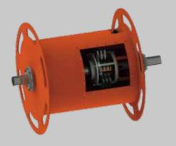
卷筒内部的电滑环结构紧凑,载流能力强。 采用特殊的铜石墨碳刷,匹配锡青铜铜滑道 ,形成良好的摩擦副,碳刷和滑环易形成氧 化膜,降低磨耗。
